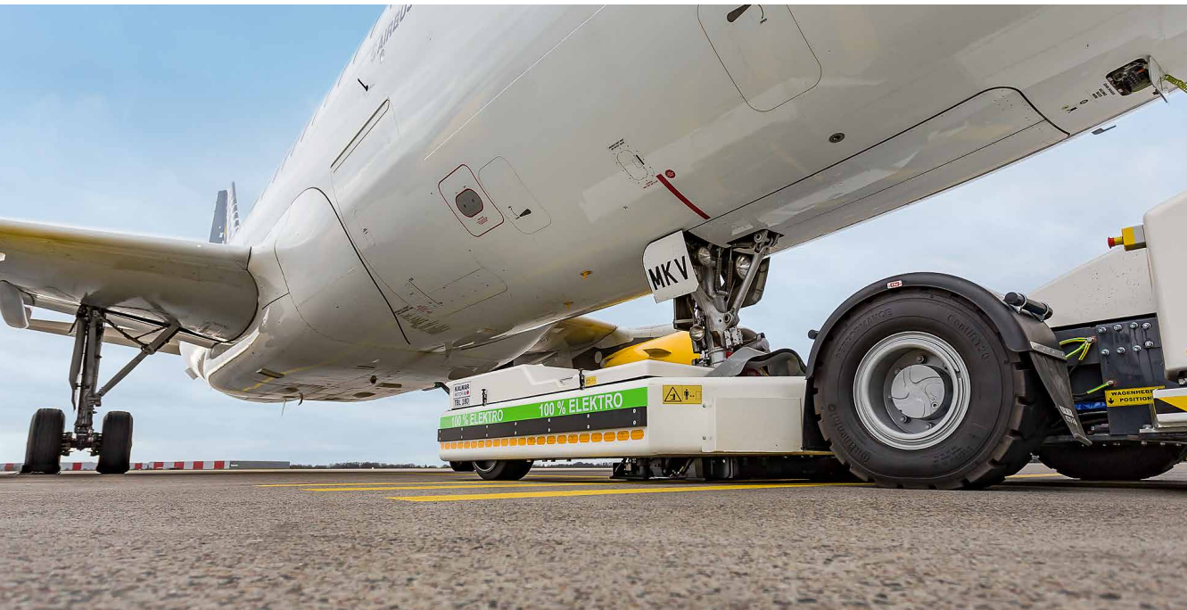
Elektrische Power: Die Push-back-Fahrzeuge am HAJ schleppen bis zu 280 Tonnen.
