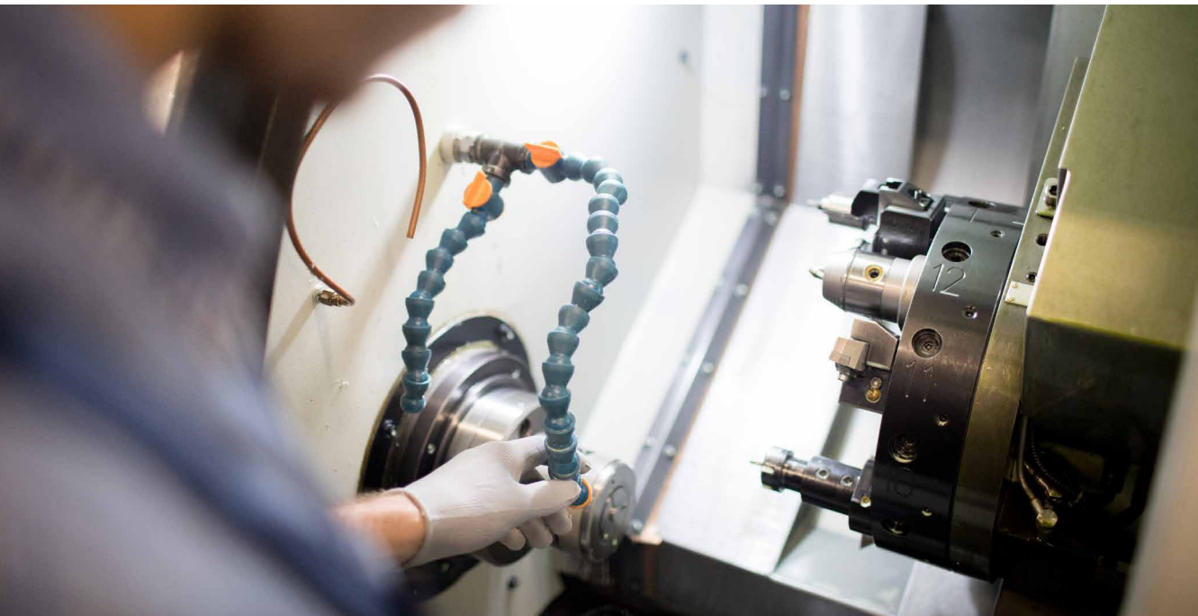
Das Kühlschmiermittel kühlt das Werkstück während der Bearbeitung und vermindert den Flug von Spänen.
