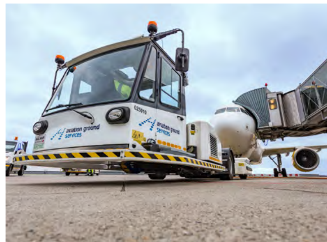
Pushback-Fahrzeug mit elektrischem Antrieb
