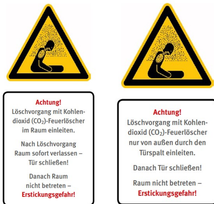
Abbildung 17: Hinweisschilder für den Einsatz von CO 2 -Löschgeräten
