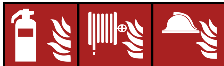
Abbildung 16: Hinweisschilder für Feuerlöscher (links), Löschschlauch (mitte) und Mittel und Geräte zur Brandbekämpfung (rechts)
